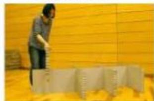
1 部材Bの溝に部材Aの溝をはめていく
